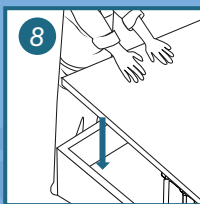
Depois do sistema de amortecedor montado, force a alavanca para baixo. Três vezes são suficientes. Fig. 08.
